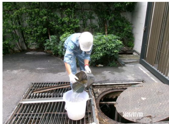
รูปที่ 3-11 คุณภาพน้ำทิ้งก่อนการบำบัด บริเวณบ่อกักน้ำพร้อมตะแกรงดักขยะ
